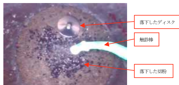
図6 模擬吸着塔内に落下したディスクおよび切粉
