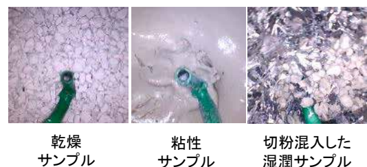
図4 内視鏡治具および確認時の映像
