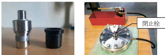
図9 閉止栓及び耐圧試験の状況
