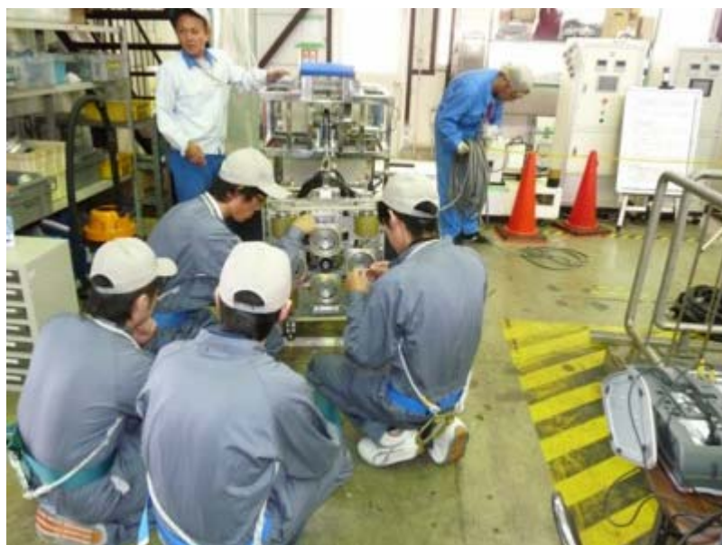
壁面除染装置 組立て状況 2
