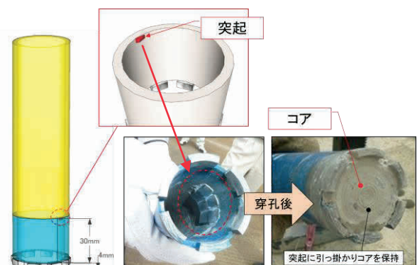
図1 穿孔刃の概要
