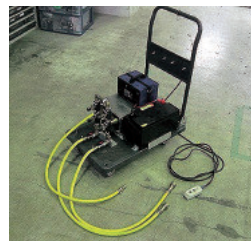
写真2 水圧ユニットの外観
