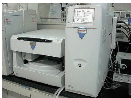
イオンクロマトグラフ 分析装置 (IC)
