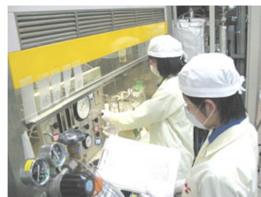
ヨウ素除去用活性炭性能試験
