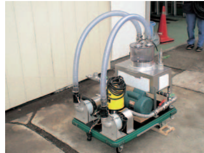
写真3 廃液回収・移送ユニット外観
