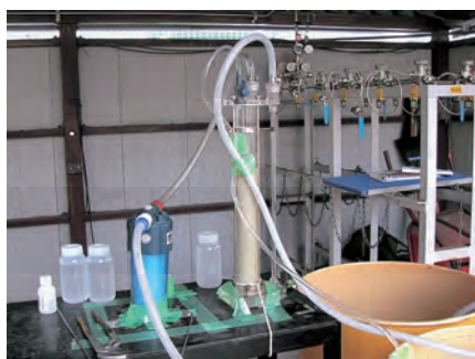
写真1 ゼオライト充填カラムによるセシウム吸着試験
