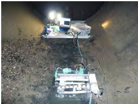
写真1 実具による除貝試験
