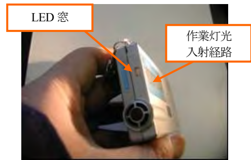
写真 3 作業灯光進入経路
