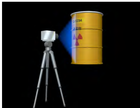
図2 ラインカメラでの撮影イメージ
