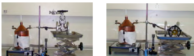
写真1 水蒸気処理試験外観(左:縦置き、右:横置き)
