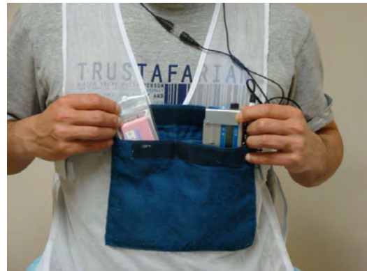
写真 4 現場での APD-VU 装着状況
